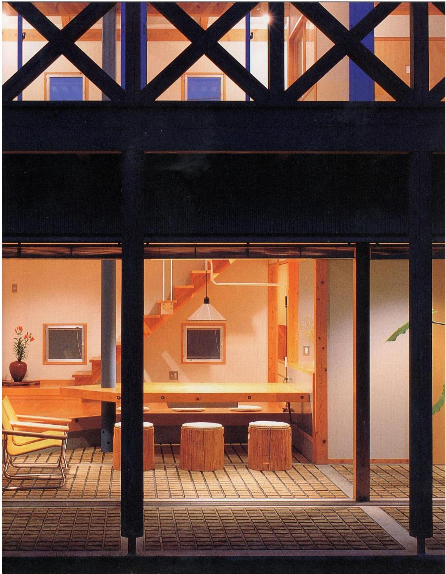
広間と茶の間 土間に木煉瓦が1間角で敷かれている ダイニングテーブルはヒノキの無垢を使用(設計者製作) イスは東南アジア製でスギ丸太の上にバナナの皮で編んだ座布団がのったもの
