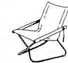
NY チェア X ヤング (1972) 前脚の交差部が脚に当たらないよう変形
